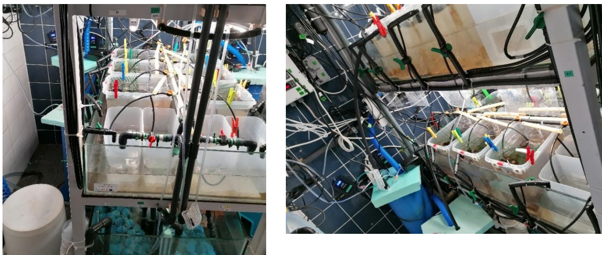
Figura 2.1: Sistemas aquáticos utilizados durante a experiência. São visíveis tanques replicados, colunas de desoxigenação, controladores e reservatórios de filtragem biológica.
