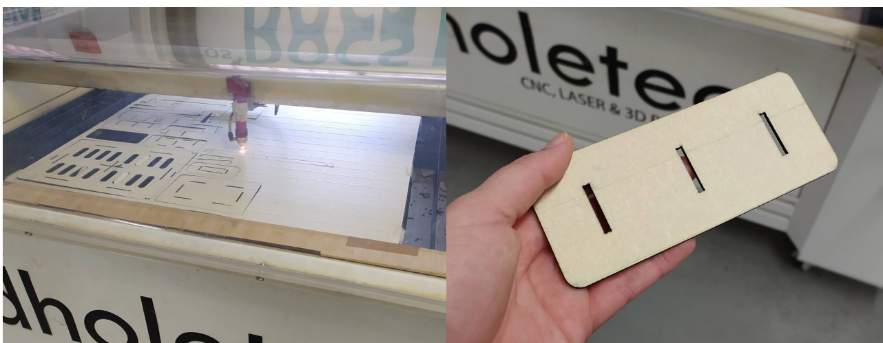
Figura 43. Processo de corte a laser, no FabLab de Sintra. Fontes: Autora, 2022
