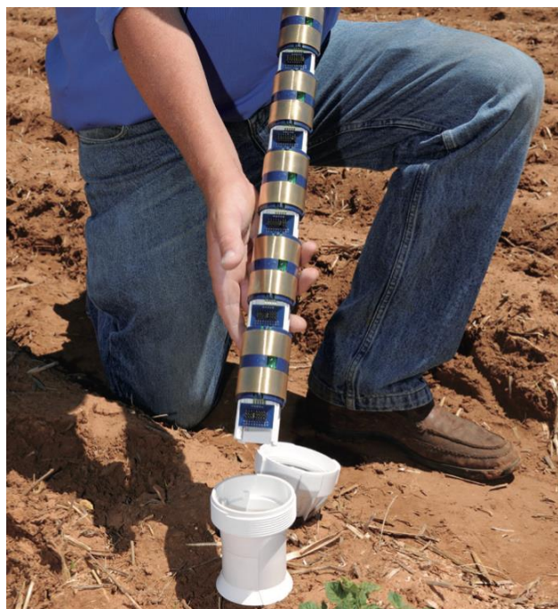
Figura 14 - Exemplo de sonda capacitiva. Sonda EnviroSCAN (Sentek, 2020).
