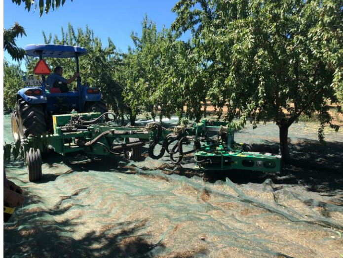
Figura 33 -Trator acoplado com vibrador telescópico, em posicionamento para a vibração, controlado por operador no terreno. Solo coberto por panos verdes de colheita.
