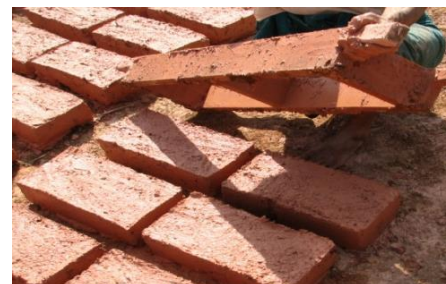
Figura 66 - Blocos de terra compactada (BCT)
