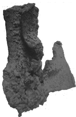
Fig. 4.14. Peça de ferro forjado que se fundiu no fogo de Bayonne (in Ransome, 1912: 186).
