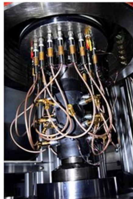
Figura 5.4 – Em cima, a amostra de basalto preparada para ser colocada na ST100. As peças douradas são os transdutores e os fios metálicos estão ligados aos sensores de deformação. Ao lado, a amostra colocada na prensa rodeada pelos transdutores ligados à central.
