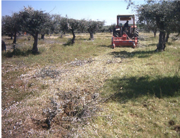
Figura 3 – Destroçador e incorporação do material de poda no solo, no Alentejo.
