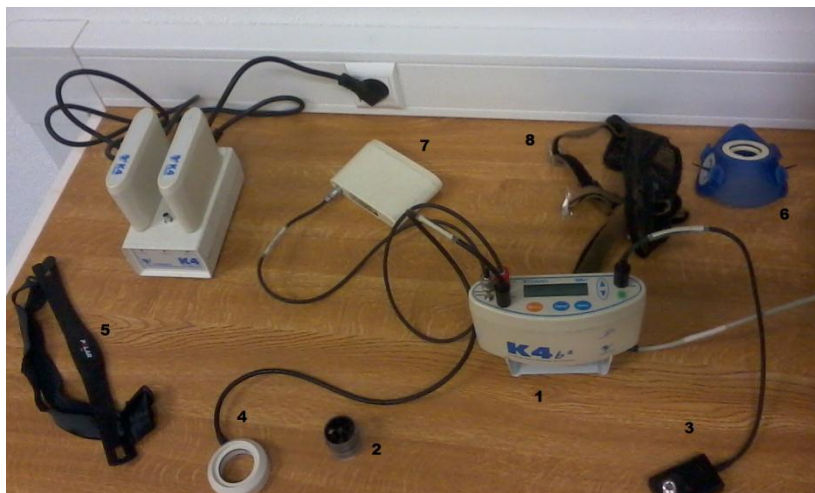
Figura 1: 1) Unidade K4b 2 ; 2) Turbina; 3) Sonda de FC; 4) leitor optoelectrónico; 5) Cardiófrequencímetro; 6) Mascara; 7) Bateria
