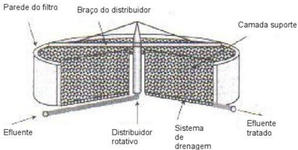
Figura 5. Esquema de filtro de leito percolador (adaptado de Metcalf e Eddy, 2003).
