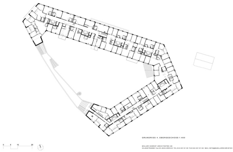
Figura 9: Planta do 4º Piso do Edifício Kalkbreite , desenho de Muller Sigrist Architekten. Retirado de https://www.archdaily.com/903384/kalkbreite-muller-sigrist-architekten . Acedido a 8 de Setembro de 2021.
