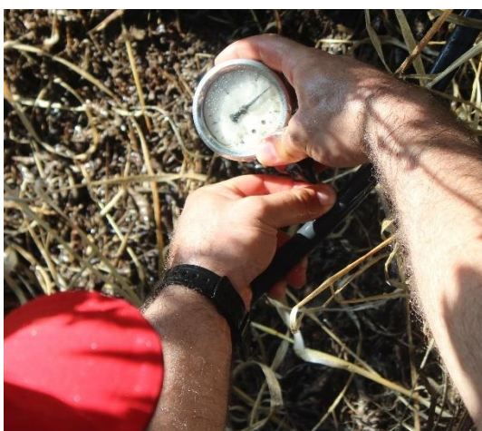
Figura 26 - Medição da pressão no início da rampa.
