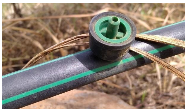
Figura 22 - Gotejador autocompensante utilizado no sistema de rega.
