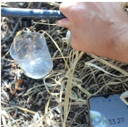
Figura 25 – Exemplo de recolha do volume de água do gotejador.
