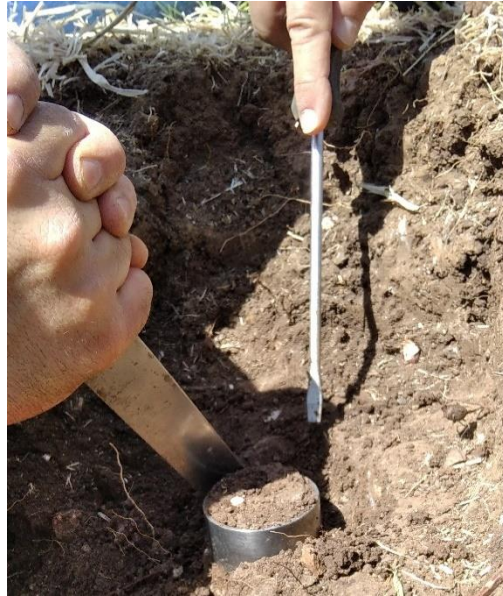
Figura 8 – Recolha de amostra não perturbada.
