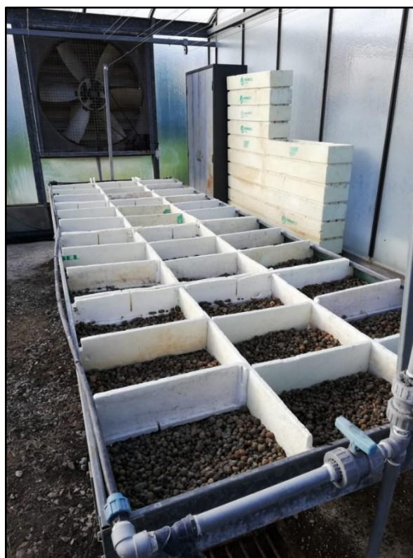
Figura 15 - Bancada com divisórias em esferovite, onde foi montado o Ensaio 2.
