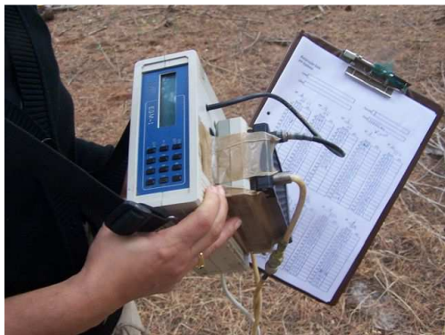
Câmara de respiração do solo e analisador de \text{CO}_2 EGM-1 da marca PP-Systems (esquerda); Sonda PR1 da marca Delta-T para medição da humidade do solo (direita)
