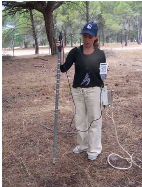
Câmara de respiração do solo e analisador de \text{CO}_2 EGM-1 da marca PP-Systems (esquerda); Sonda PR1 da marca Delta-T para medição da humidade do solo (direita)
