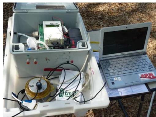
Câmara de luz (esquerda), câmara escura (centro) e analisador de CO 2 e H 2 O Li840a, da marca Li-Cor (direita)
