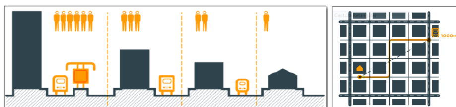
FIGURA 2.7 Viabilidade e Acesso ao transporte público Relação entre a demanda mínima para garantir viabilidade e frequência com a distância máxima de 1.000m a pé (15 min) ou bicicleta (5 min) ao acesso ao Transporte Público in Oppermann, Caccia, & Samios, 2015
