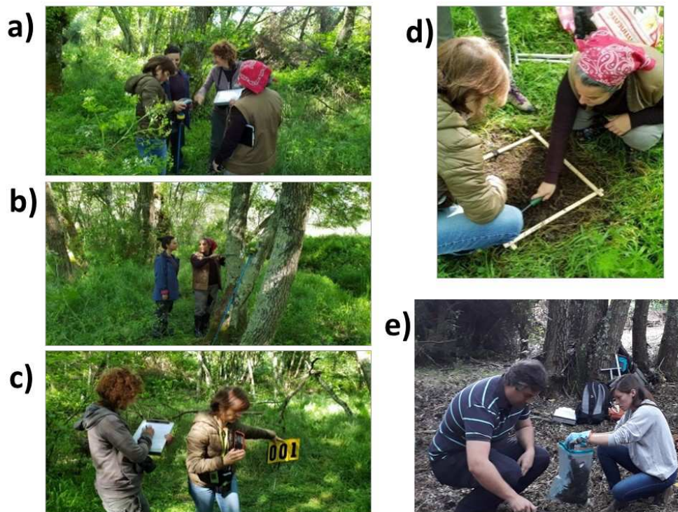
Figura 3 – Ilustração das diferentes fases de recolha de dados: a) obtenção da coordenadas GPS do ponto central do parcela circular, b) medição do DAP de todas as árvores dentro da parcela, c) preenchimento da ficha de campo e recolha de fotos d) recolha da folhada numa amostra quadrada (50cm*50cm), e) recolha de solo com sonda de meia-cana de 20 cm de profundidade.
