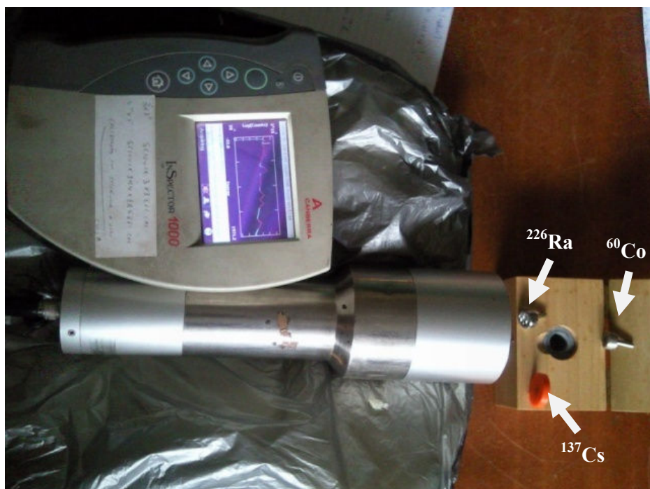
Figura 16: Calibração em energia do detector InSpector 1000, utilizando três fontes ( ^{226}\text{Ra} , ^{137}\text{Cs} , ^{60}\text{Co} ).
