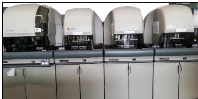
Figura 1. UniCel® DxH 800 series. Conjunto de três equipamentos alinhados em cadeia ( direita ). O equipamento UniCel® DxH Slidemaker Stainer ( esquerda ) executa esfregaços de sangue e respetiva coloração.
