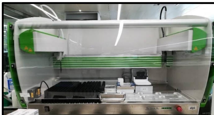
Figura 23. Equipamento automático Sprinter XL ® utilizado na detecção de anticorpos antinucleares.
