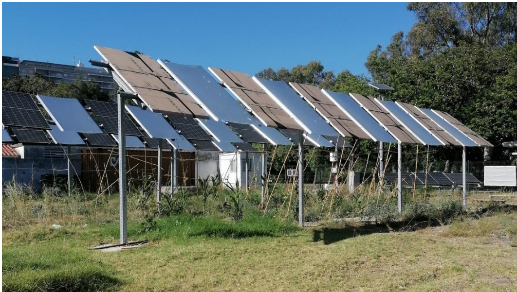
Figura 3.5 - Módulos bifaciais cobertos com as placas de cartão.
