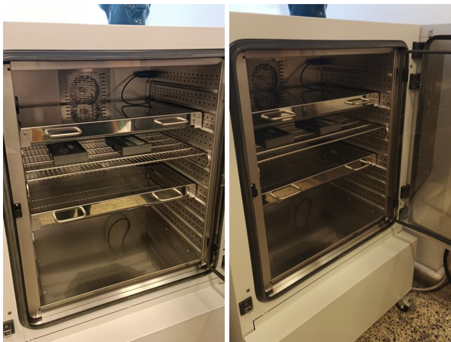
Figura 16 – Fotografia das cassetes na câmara climática da Binder®,
