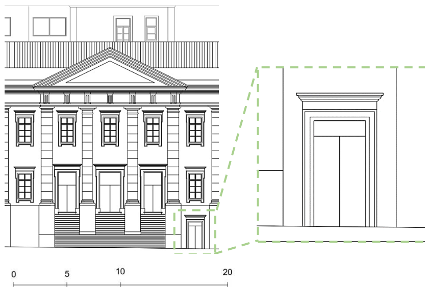
Figura 5.3. – Entrada Mobilidade Condicionada em Alçado Sul Parcial | Fonte: Autora
