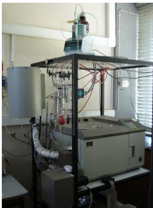
Figura 22: Instalação catalítica usada na reacção de hidrogenação do tolueno.
