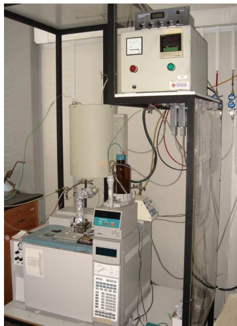
Figura 24: Instalação catalítica usada na reacção de hidroisomerização do n-decano.
