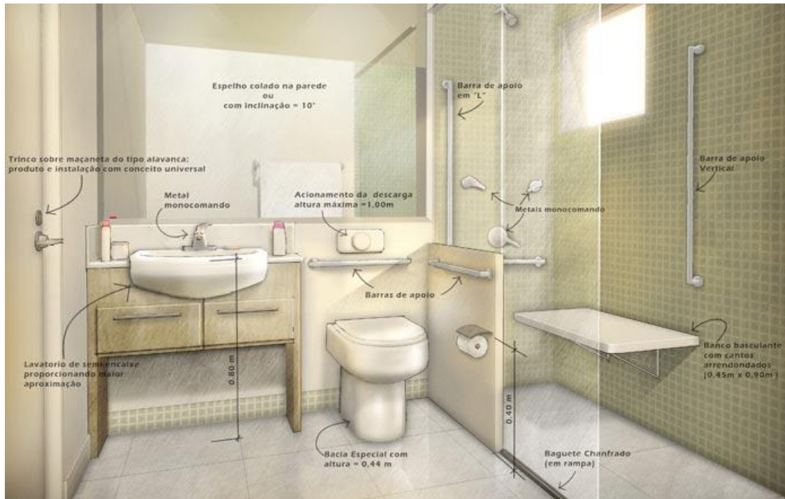
Figura 38 - medidas adequadas do WC para idosos Fonte: Google
