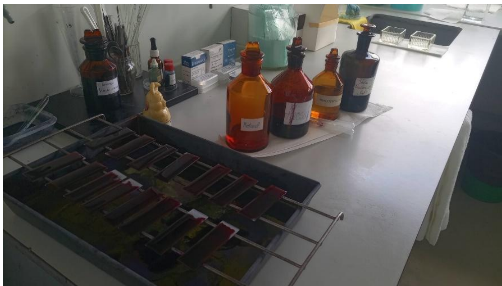
Figura 3 Esfregaços corados com o método de Ziehl-Neelsen modificado com os reagentes envolvidos por ordem de utilização da esquerda para a direita: metanol, fucsina, álcool clorídrico a 1% e verde malaquite a 0,4%) (Original).
