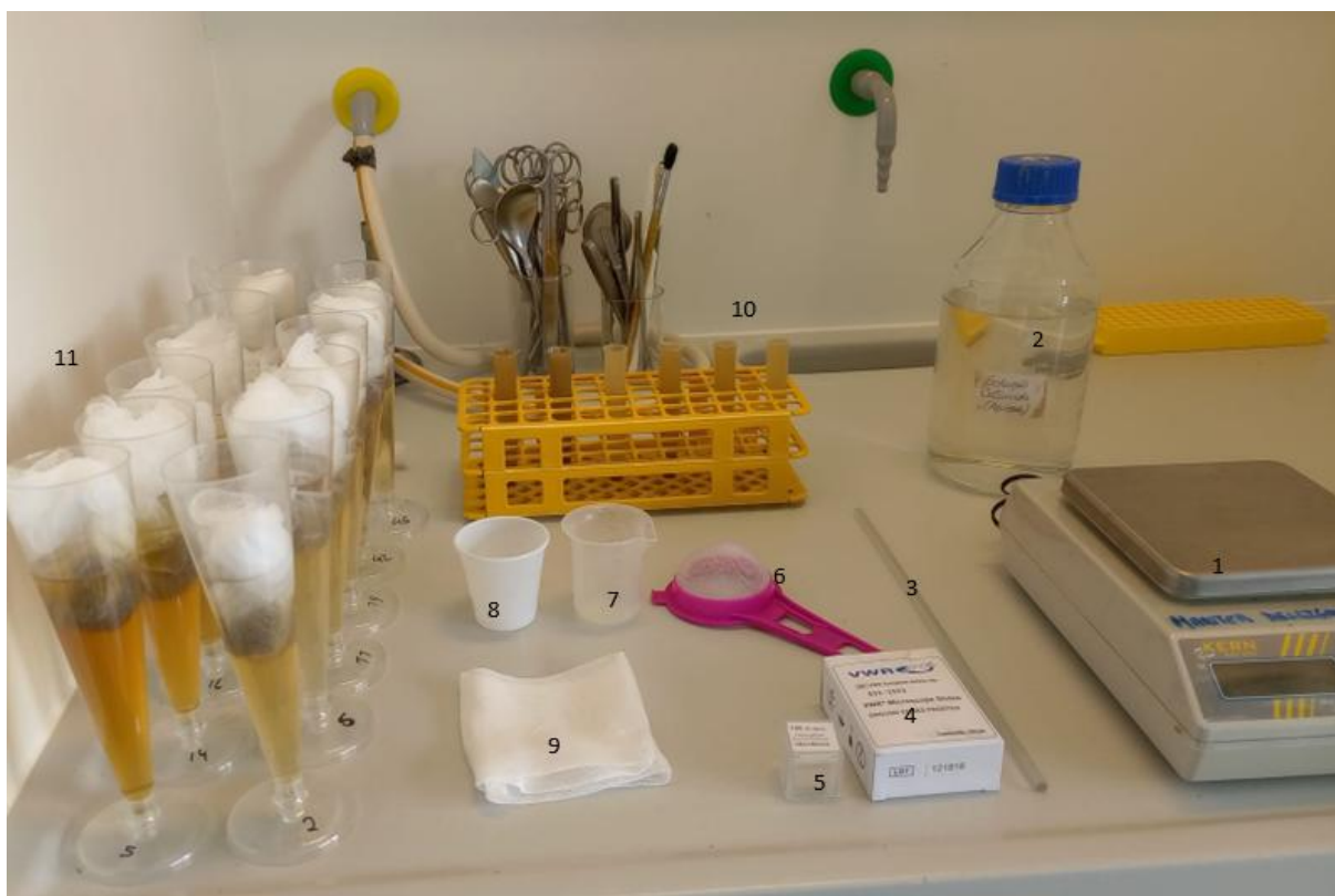
Figura 4 Materiais para os métodos de sedimentação, flutuação e de Baermann. Legenda: 1- Balança; 2- Solução concentrada de açúcar; 3- Vareta de vidro; 4- Lâminas; 5- Lamelas; 6- Passador de rede; 7- Goblé; 8- Copo descartável de plástico; 9- Gaze; 10- Suporte e tubos de ensaio onde se está a dar a sedimentação e a flutuação; 11- Copos de champanhe com as bolsas de gaze para o método de Baermann (Original) .
