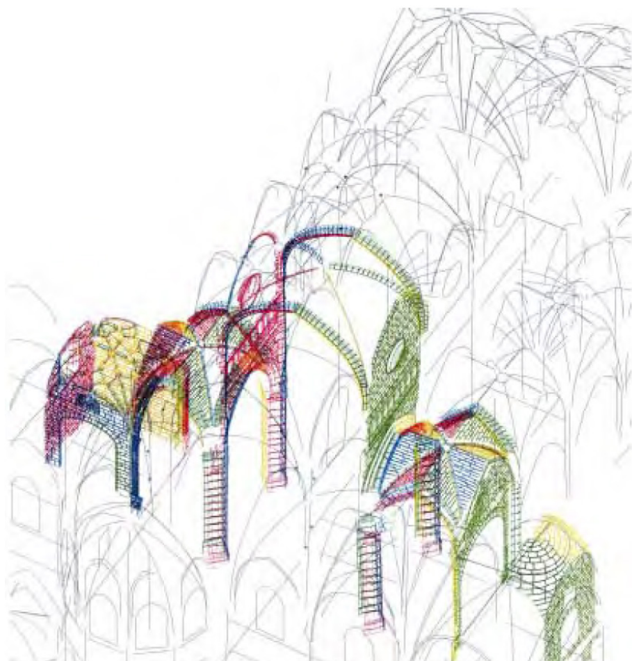
Imagem 83: Levantamento tridimensional da Catedral. Nesta imagem vemos desde as formas mais simples à complexidade de informação que estes levantamentos fornecem.
