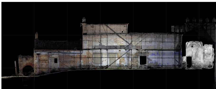
Imagem 256: Fachada Norte. Levantamento efectuado com recurso a varrimento laser da autoria de Luis Mateus.
