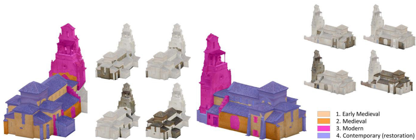
Imagem 61: Sequência Evolutiva da Igreja de San Cebrián de Mazote com recurso do levantamento fotogramétrico.
