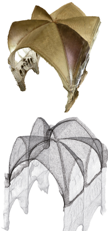
Imagem 57: Modelo fotográfico realizado por Fotogrametria e posteriormente convertido em nuvem de pontos. Catedral de Bourges por Rocio Maira Vidal.
