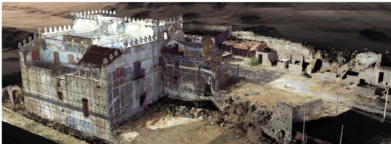
Imagem 54: Levantamento por Varrimento Laser do Palácio de Valflores por Luís Mateus. Imagem da nuvem de pontos obtida.
