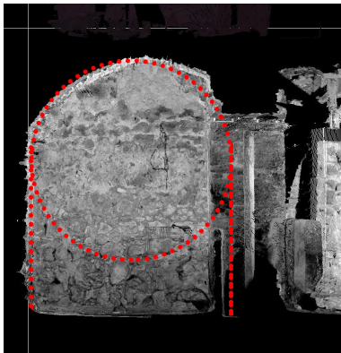
Imagem 289: Corte pela abóbada do piso intermédio do Palácio Valflores. A vermelho, esquema da abóbada original que existiria na Fase 1. Imagem proveniente do varrimento laser realizado por Luís Mateus.
