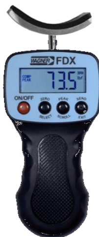
Figura 4. Algómetro com o aplicador usado no estudo para a pressão sobre o metatarso.
