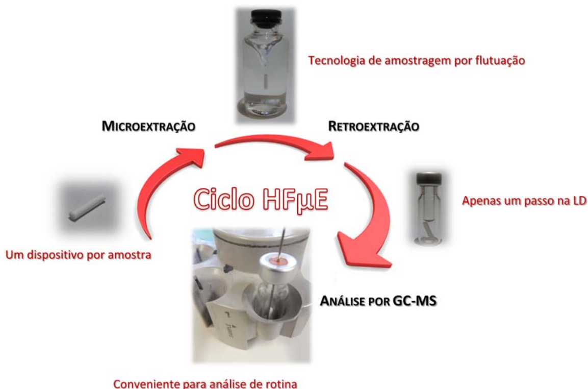
Figura 7.3. Procedimento experimental proposto no ciclo HF \mu E.
