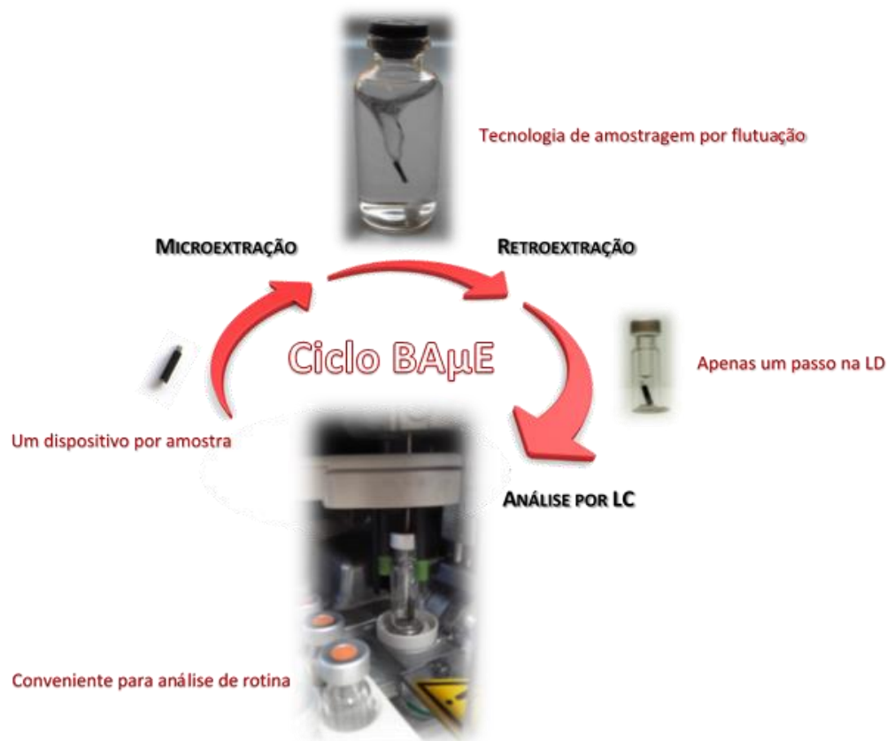
Figura 5.3. Procedimento experimental proposto no novo ciclo BA \mu E.
