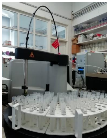
Figura 11 – Análise laboratorial de azoto mineral no solo realizada em auto-analisador de fluxo segmentado (Skalar).
