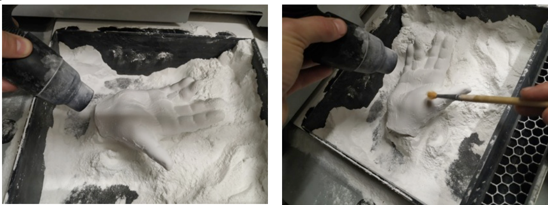
Figura 59: Mão em gesso a ser retirada da impressora 3D. Foto: Henrique Costa
