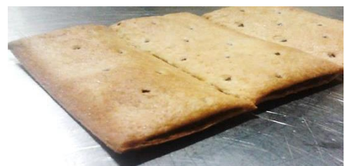
Figura 16: Perfuração do manto descentralizada: bolacha com bolha
