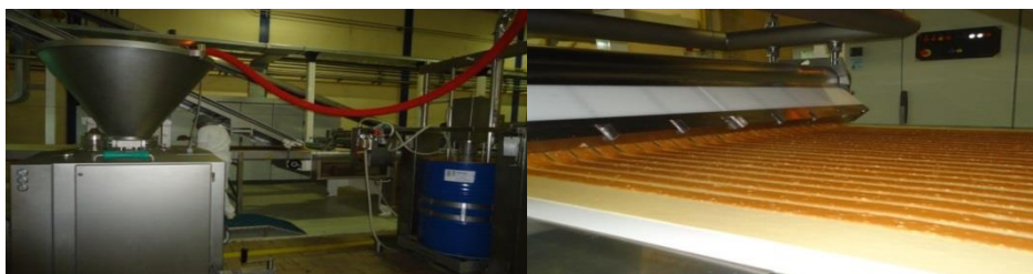
Figura 6: Bomba e máquina de enchimento (à esquerda) e bocas injetoras de geleia (à direita)
