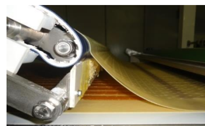
Figura 7: Sobreposição do manto superior de massa Newkcal no manto inferior
