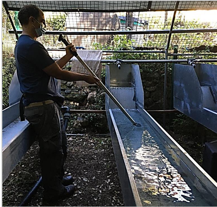
Figura 2.9. Medição da velocidade do fluxo da água dos canais, com o molinete (Global Water Instrumentation, Inc., USA, mod. FP-101).
