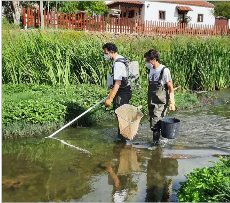
Figura 2.3. Captura de peixes, recorrendo ao método de pesca elétrica (Hans Grassl IG-200).
