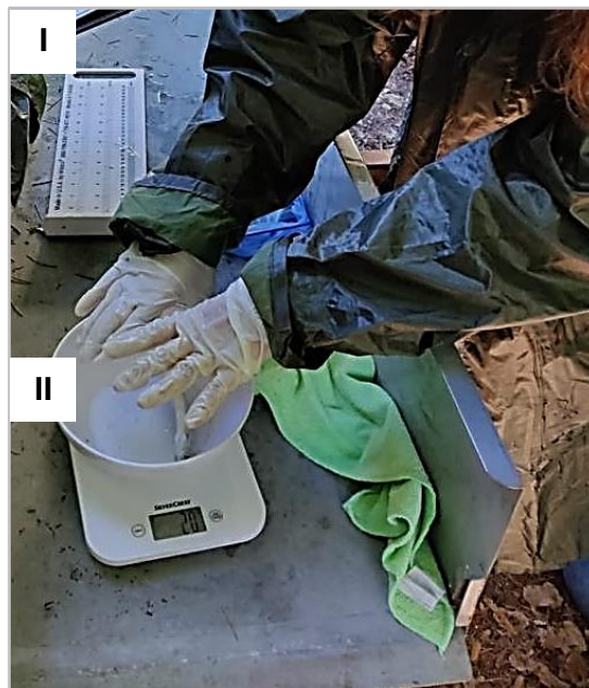
Figura 2.8. Medição do comprimento dos peixes com um ictiómetro (I) e pesagem dos mesmos com uma balança (II).
