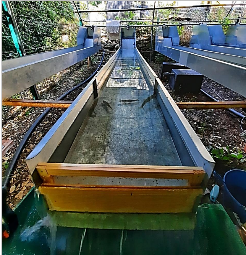
Figura 2.4. Sistema de mesocosmos do ISA, constituído por 6 canais artificiais externos de zinco.
