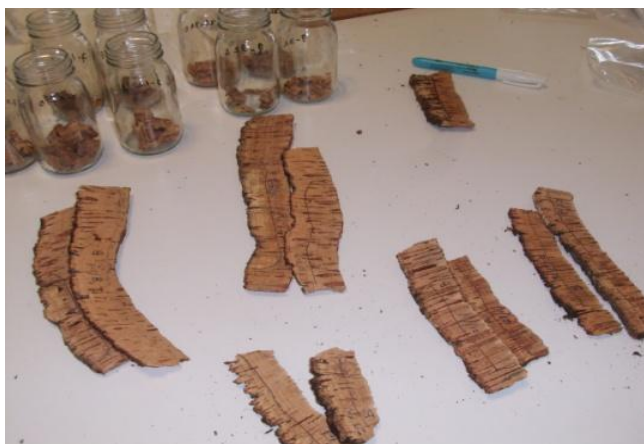
Figura 9 - Aparas de cortiça com MA de onde foram cortados os pedaços para determinação dos valores de TCA
