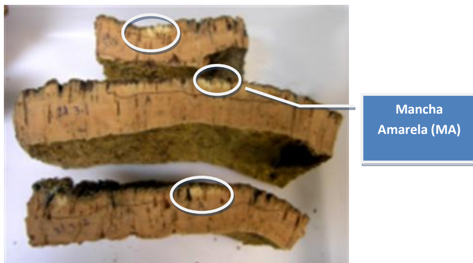
Figura 7 – Pranchas de cortiça com mancha amarela (MA)
