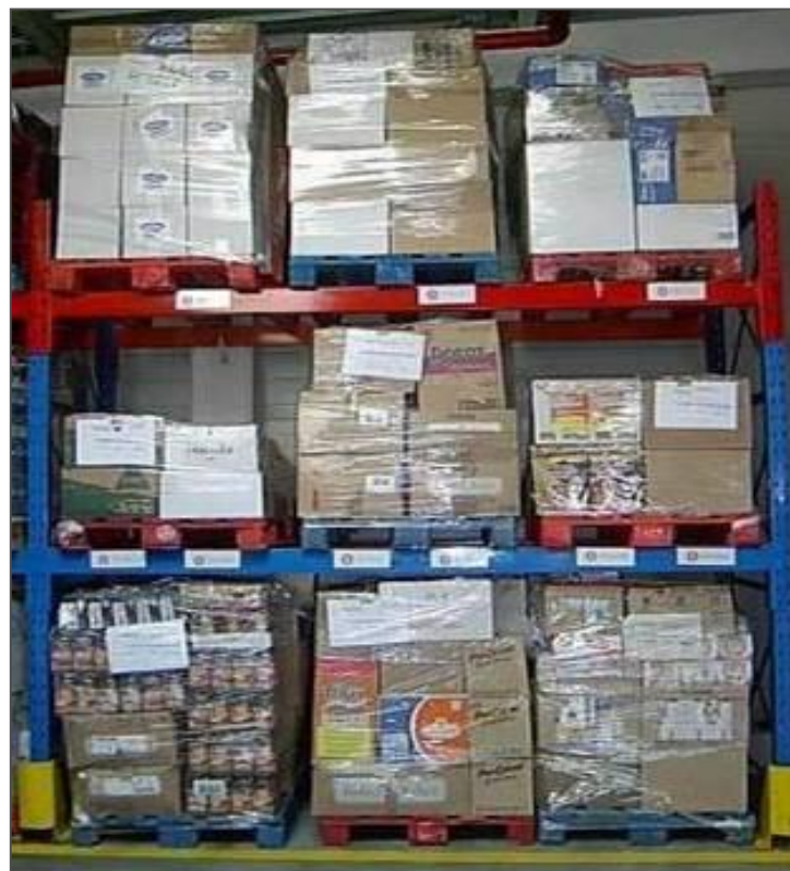
Figura 5: Colocação de paletes em rack tendo em conta o seu nível de rotatividade. Vermelho, artigos com menor rotatividade, excedentes de campanhas e descontinuados; Azul, artigos de multi-reposição.
