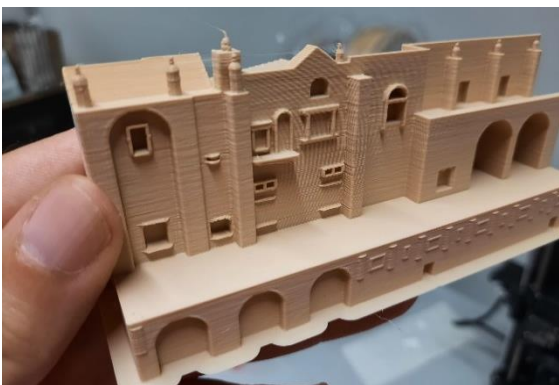
Figura 101- Fotografia do teste de impressão do alçado sul. Fonte:
