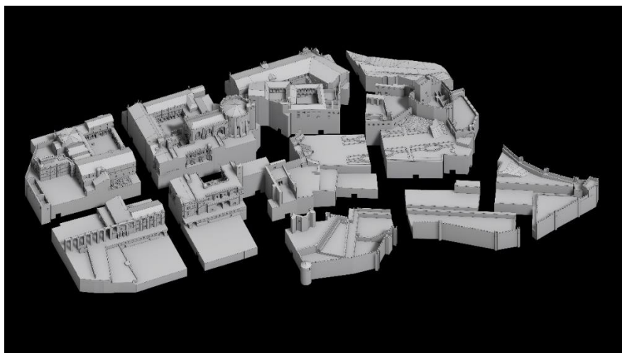
Figura 93- Modelo tridimensional do Convento de Cristo separados nas respectivas peças de impressão. Fonte: Victor Ferreira
