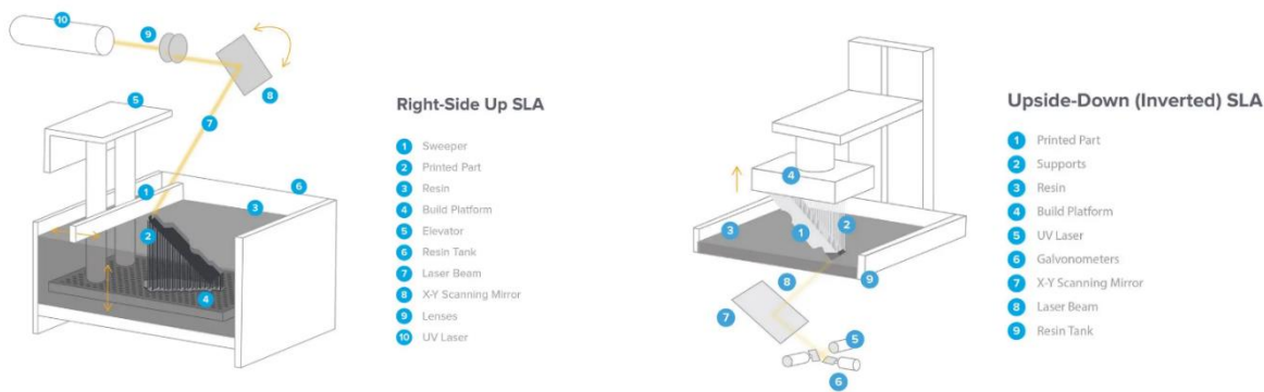
Figuras 17 e 18- Ilustração esquemática dos componentes do método de impressão Stereolithography tradicional (à esquerda) e do método invertido (à direita). Fonte: https://formlabs.com/eu/blog/history-of-stereolithography-3d-printing/ , consultado Fevereiro 2023
