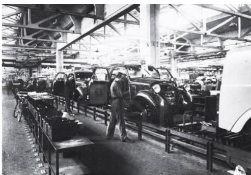
Fig. 47 - Linha de montagem do Fiat 500 B (1948), in Giacosa, D. (2014)
