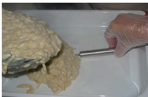
Figura 5 – Introdução das sondas “data-loggers” nos tabuleiros.
