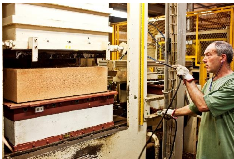
Fig. 33 – Prensagem dos blocos de aglomerados de cortiça.
