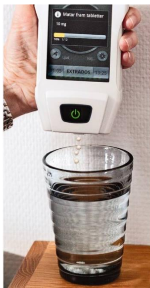
Figura 5- Dispensador automático de doses para microcomprimidos de L-dopa/carbidopa (23)
