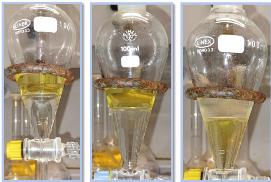
Figura 7.25 - Estudo da molaridade de HCl na fase aquosa - separação de fases na ampola após extração de solução modelo 50 mg/L Pd(II) em 1M HCl (esquerda), 6M HCl (centro) e 8M HCl (direita), com solução orgânica 0,02M DMDCHTDPA em tolueno (30 min, 700-800 rpm, A/O=1, T amb ).
