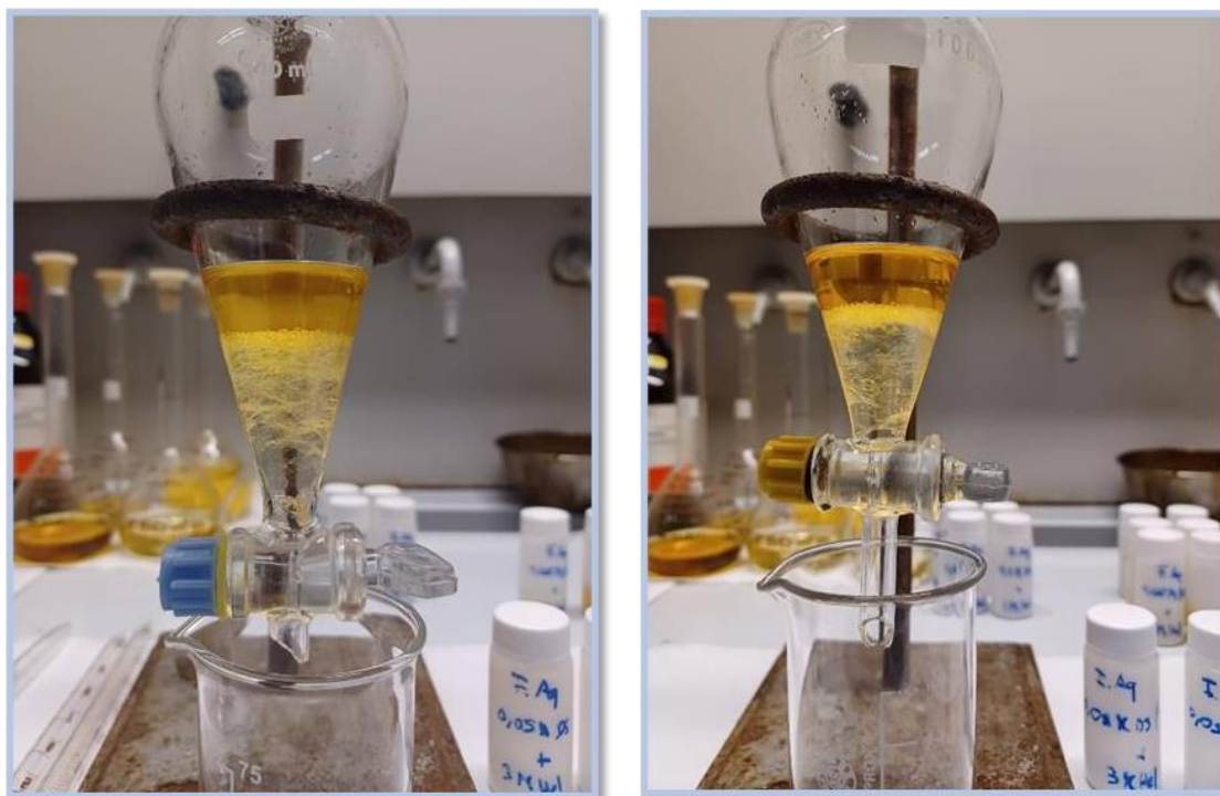
Figura 7.29 - Estudo de adição de modificadores ao Di-Sulfide – separação de fases na ampola após extração de solução modelo 50 mg/L Pd(II) em 3M HCl com solução orgânica 0,05M Di-Sulfide em tolueno/decanol 5% (v/v) (esquerda) e tolueno/decanol 10% (v/v) (direita) (15 min, 700-800 rpm, A/O=1, T_{amb} ).
