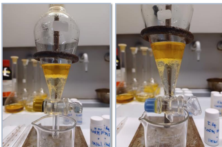
Figura 7.28 – Estudo de adição de modificadores ao Di-Sulfide – separação de fases na ampola após extracção de solução modelo 50 mg/L Pd(II) em 1M HCl com solução orgânica 0,05M Di-Sulfide em tolueno/decanol 5% (v/v) (esquerda) e tolueno/decanol 10% (v/v) (direita) (15 min, 700-800 rpm, A/O=1, T_{amb} ).
