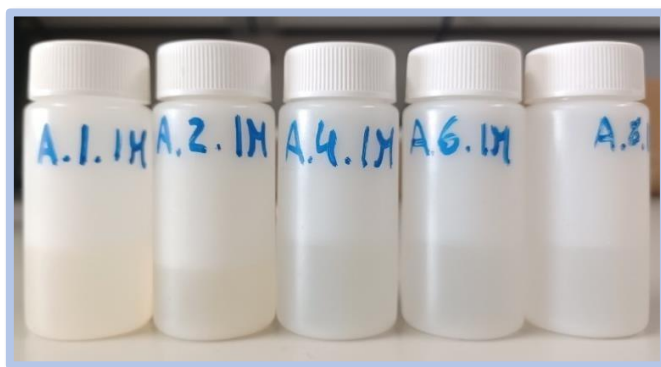
Figura 7.43 - Estudo da estequiometria Pd(II):DMDCHTDPA – fases aquosas (1M HCl) após extracção com soluções orgânicas de DMDCHTDPA em tolueno, de concentração variada (ordenadas por ordem crescente, da esquerda para a direita).
