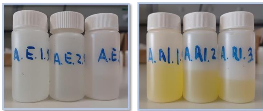
Figura 7.39 - Estudo de regeneração de DMDCHTDPA – fases aquosas após extração (esquerda) e reextração (direita) alcançadas ao longo de 3 ciclos de extração/reextração (5M HCl) (ordenados da esquerda para a direita, em ambos os casos).
