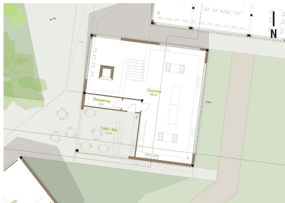
Fig. 76 - O edifício da cozinha abriga o forno, a cozinha comunitária, um pequeno depósito e o bar e cafeteria. Escala: 1/250
