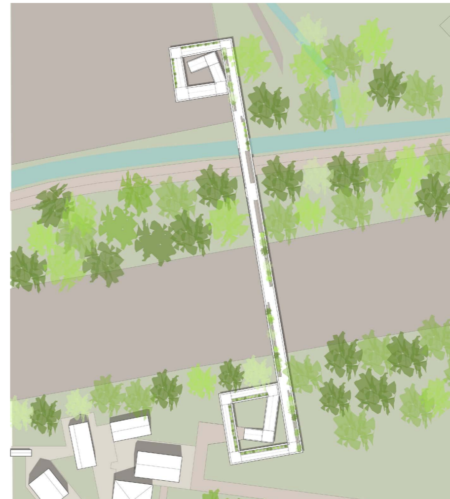
Fig. 64 - Planta da passarela e seu novo acesso.
