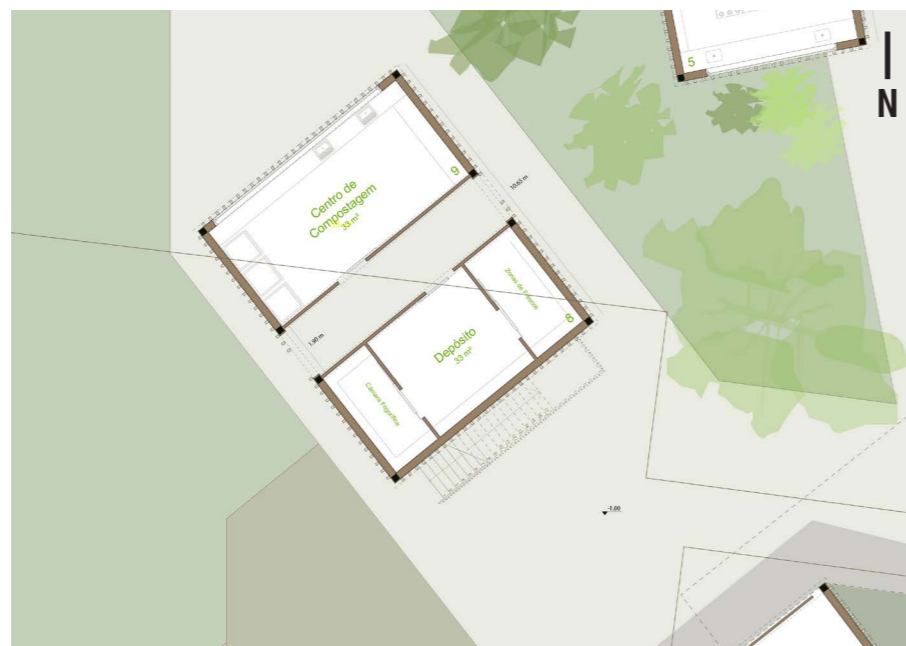
Fig. 81 - Planta do Depósito e do Centro de Compostagem. Escala: 1/250
