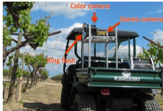
Figura 4 – Imagem do veículo experimental do ensaio de Nuske et al. (2011)
