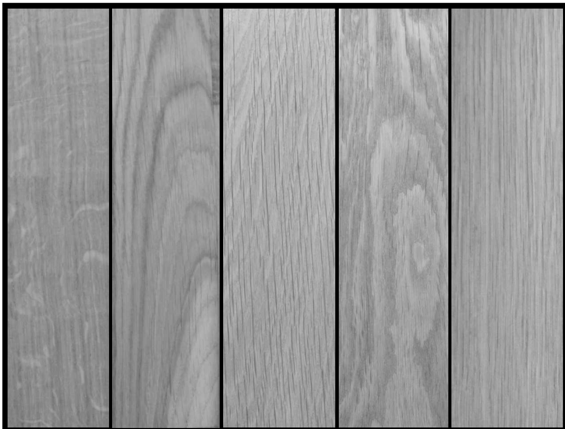
Figura 4. Exemplos do padrão da madeira de soalho de carvalho de acordo com o tipo de corte efectuado.
