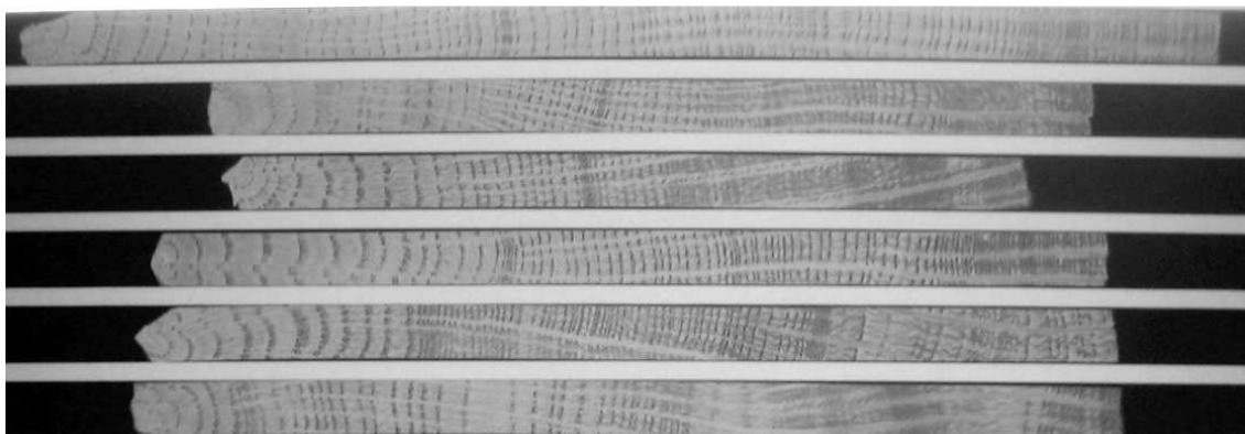
Figura 6. Superfície transversal de amostras de madeira de Q. faginea impressas em película de raios X.
