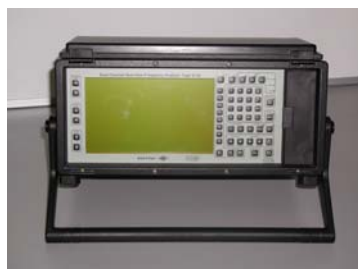
Figura 7.3 – Analisador de frequências de dois canais, em tempo real, modelo 2144, da Brüel & Kjær.
