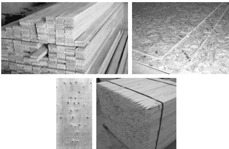
Imagens 48, 49, 50 e 51 Travessas de madeira resinosa (estrutura), OSB (estrutura), contraplacado Spruce (revestimento), estacas de fundação de madeira resinosa
