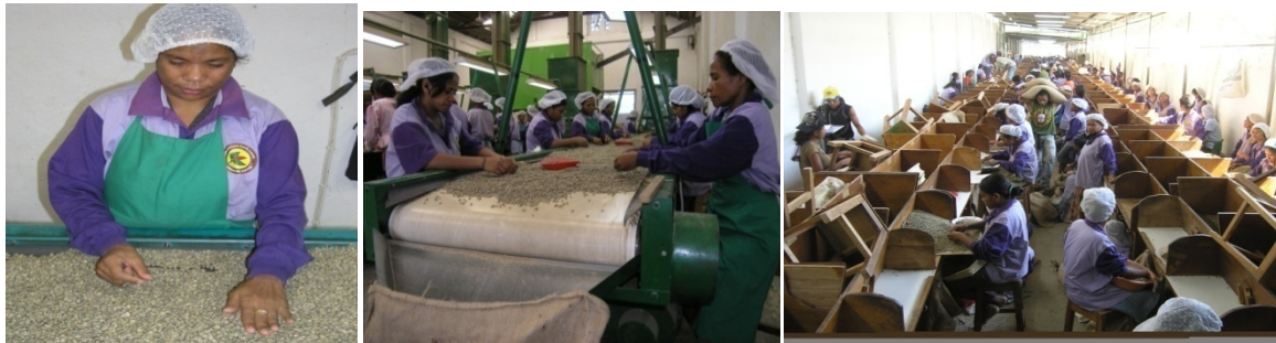
Figura 23: Escolha manual de defeitos e classificação em tipos de qualidade
