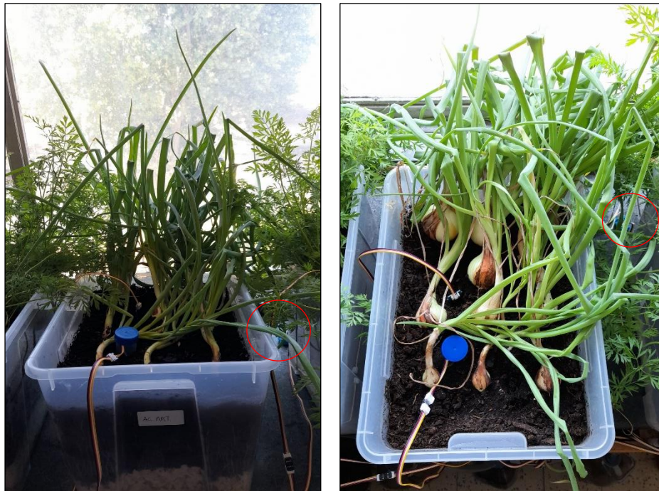
Figura 3.9. Imagens da posição do sensor de luz (rodeado a vermelho) e da rama das cebolas, que impede a exposição direta do sensor ao sol.
