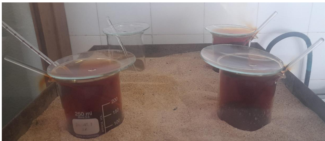
Figura 3.17. Imagem capturada após a primeira adição de ácido nítrico 65 % à amostra num banho de areia a 120 °C, em que se observam os gases resultantes da digestão a escapar do copo onde ocorre a referida digestão.
