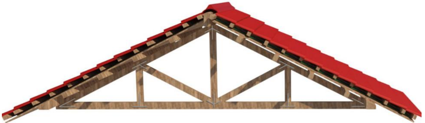
Figura 57 Pormenor de reabilitação da estrutura da cobertura, Paço
