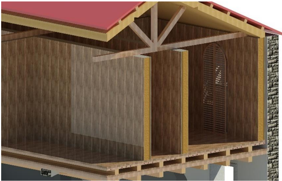
Figura 65 Corte construtivo, "Box in the Box"
