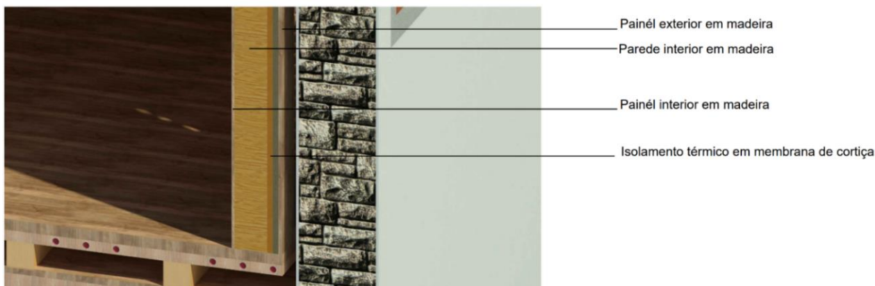
PAREDE "CAIXA" INTERIOR
