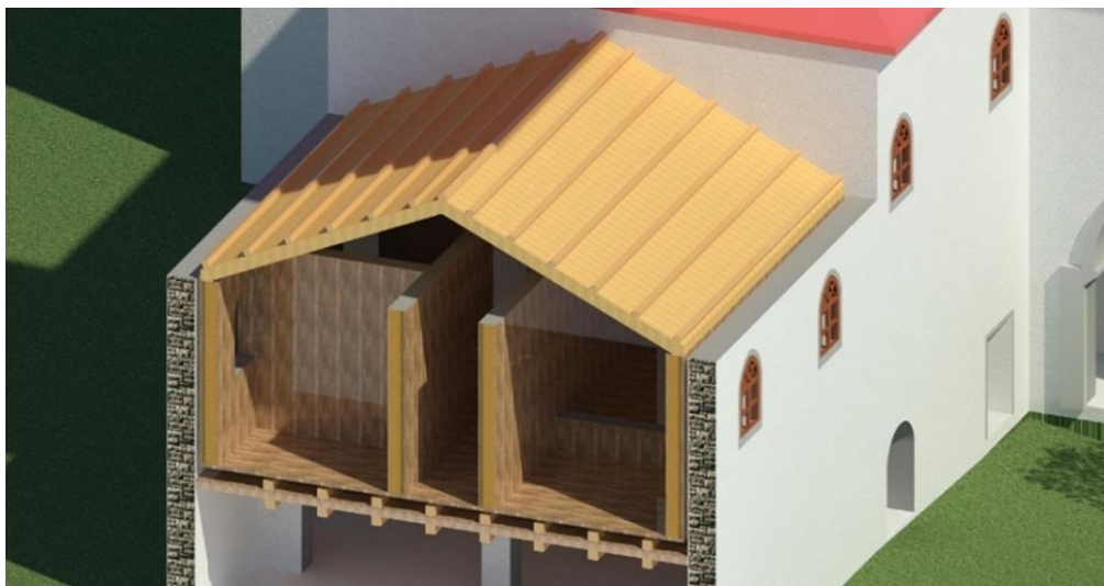
Figura 66 Corte construtivo, "Box in the Box"
