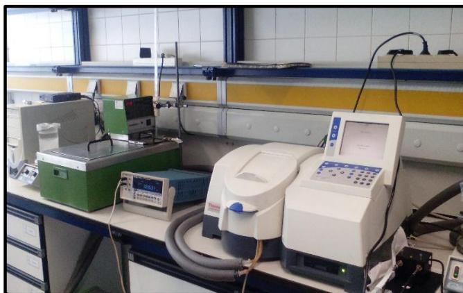
Figura 5. Espectrofotómetro (à direita) para medir os comprimentos de onda, com controlo de temperatura (à esquerda).
