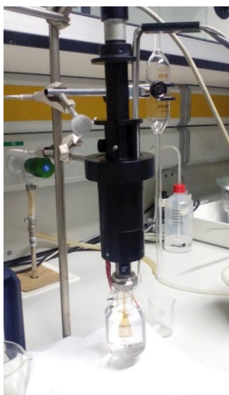
Figura 6. Braço do calorímetro, com o vaso calorimétrico incorporado.
