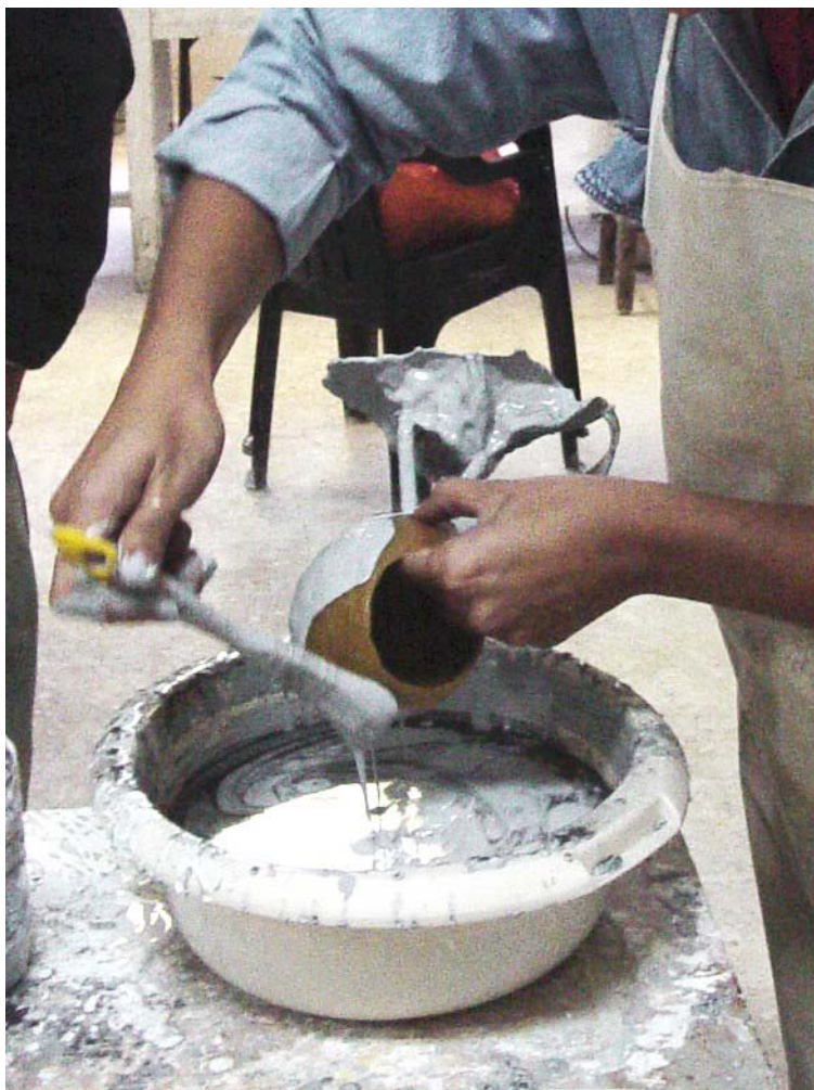
Fig. 34 - Aplicação da lama no modelo em cera.
