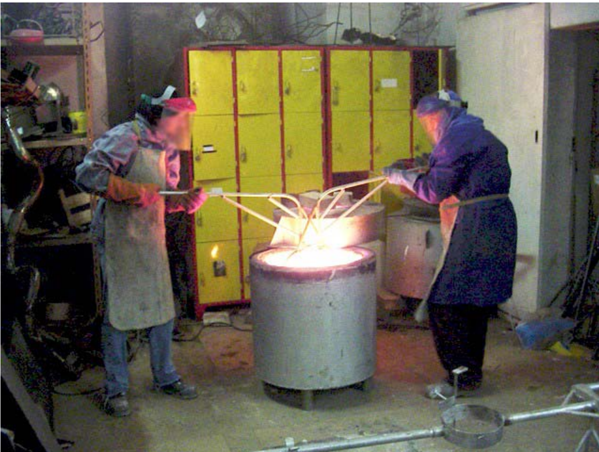
Fig. 57 - Extração do cadinho com metal fundido do forno de fundição.
