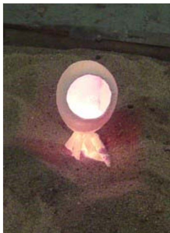
Fig. 54 - Entrada do metal na cavidade do molde.
