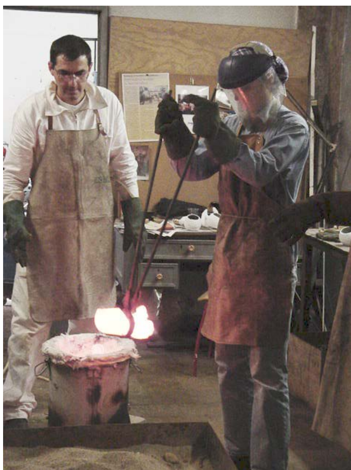
Fig. 53 - Enchimento do molde com cadinho integrado.
