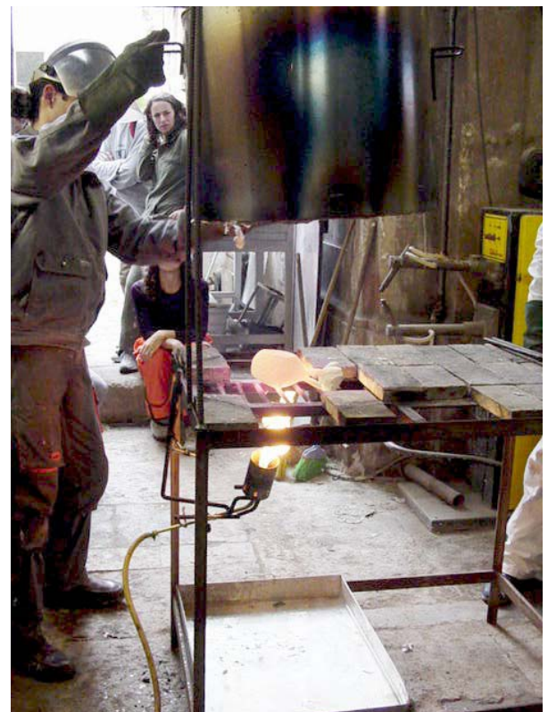
Fig. 41 - Peça com coloração rosa, sinal de que já adquiriu a resistência desejada.
