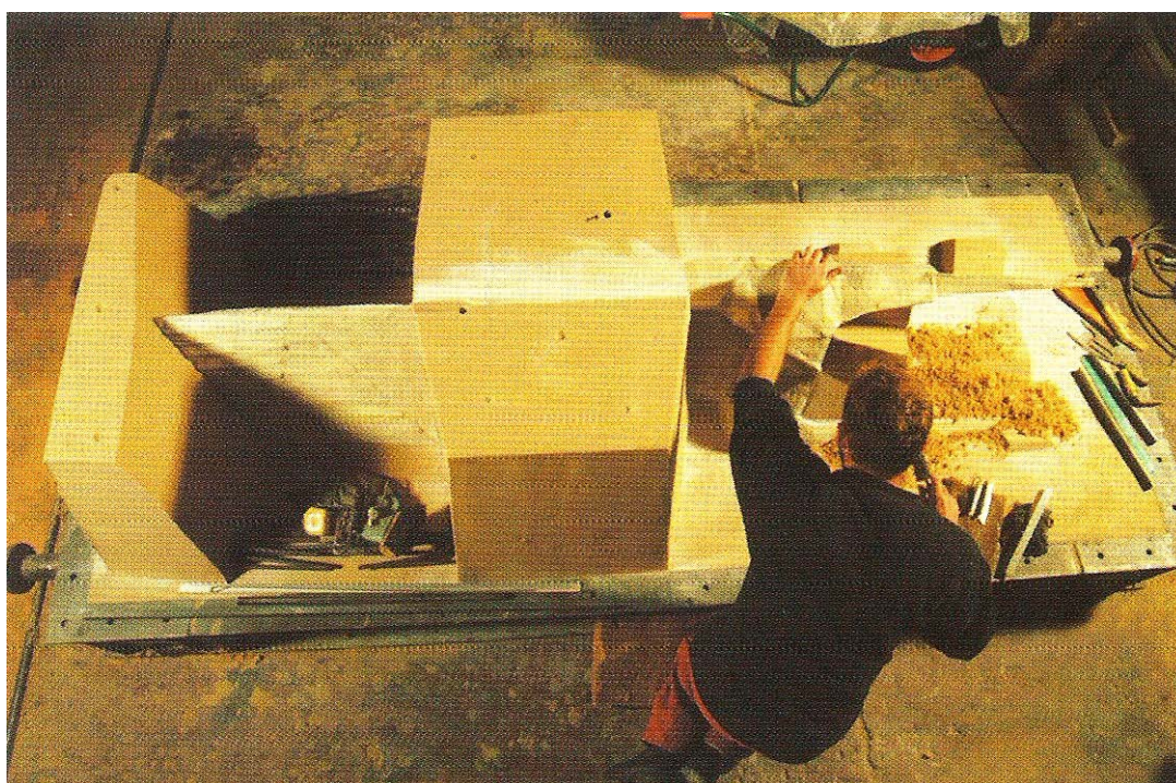
Fig. 14 - Execução dos moldes em diferentes partes.
