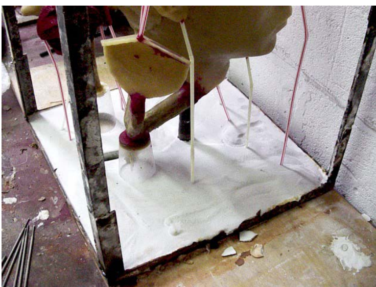
Fig. 25 - Pequena camada de chamote para fixar todos os canais à base.
