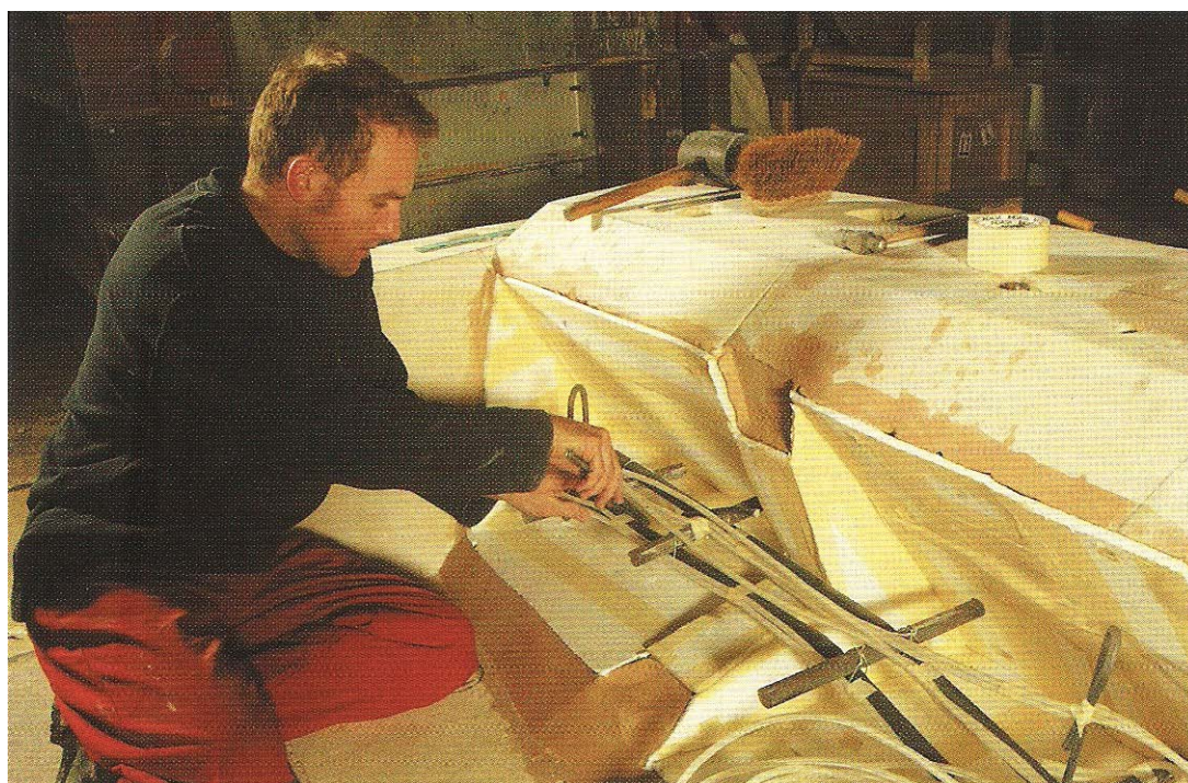
Fig. 18 - Colocação dos canais que irão estruturar e gaseificar as areias.
