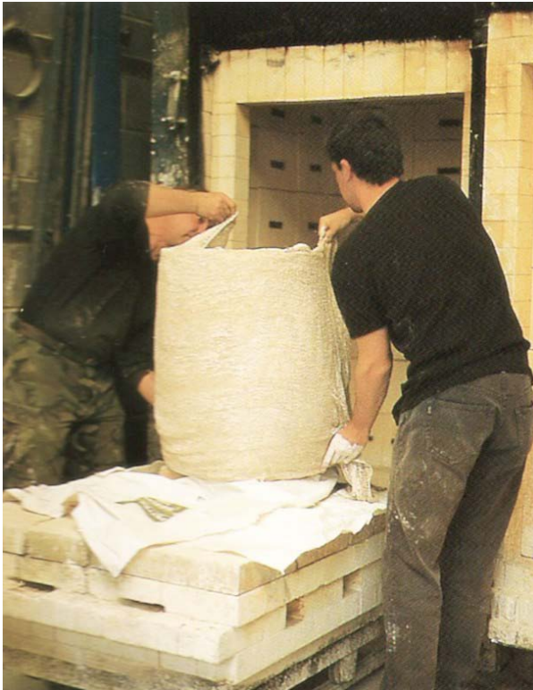
Fig. 31 - Reforço do molde com tecido embebido em gesso.
