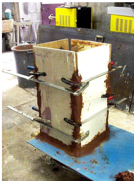
Fig. 27 - Madeiras vedadas com barro, para impedir a saída do material refractário.
