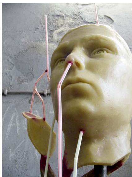
Fig. 24 - Modelo com canais de ventilação e alimentação.
