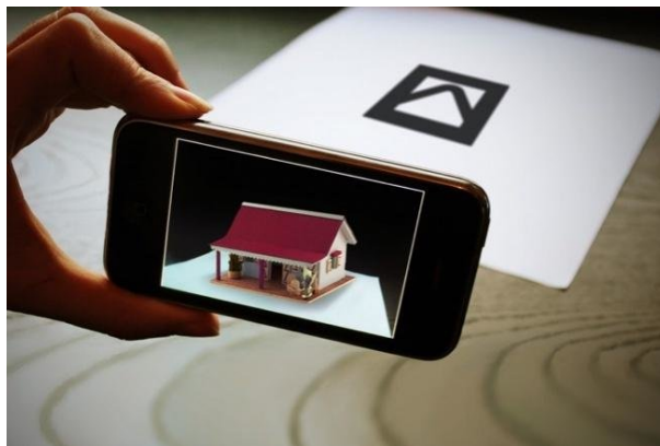
Figura 2.2: Exemplo de uma aplicação que usa marcas fiduciais para o alinhamento [24].
