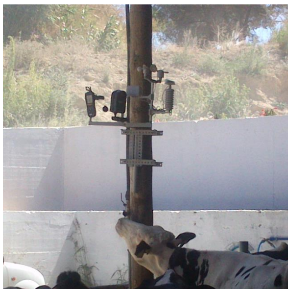
Figura 10 - Poste e suporte com os aparelhos utilizados no projeto, montado num poste da vacaria a cerca de 2,15 m do chão
